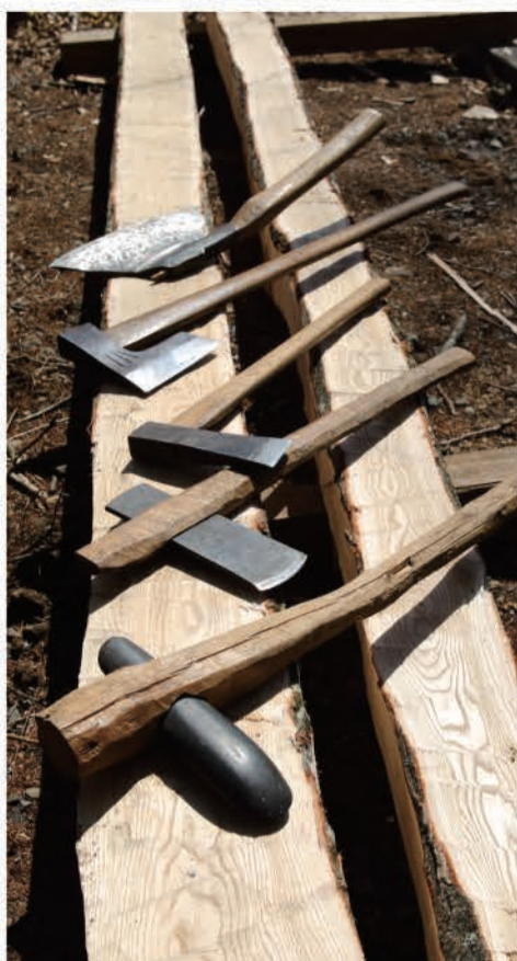
手道具の数々。いちばん手前の石斧が、道具の原点だという。伐倒から製材、刻みまでこなす万能道具。
