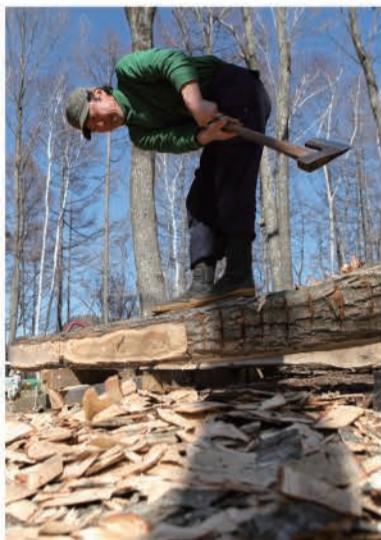
鉄斧を使って、はつる。削るというよりも剥ぎ取るという表現に近い作業だ。
